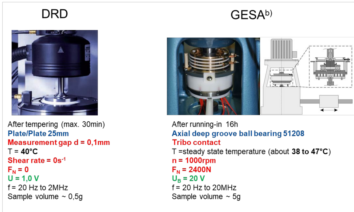
Figure 7: Comparison of DRD and GESA test parameters (b) Copyright by Lehrstuhl für Maschinenelemente, Getriebe und Tribologie (MEGT), University Kaiserslautern, reproduced by kind permission of Lehrstuhl für Maschinenelemente, Getriebe und Tribologie (MEGT)
