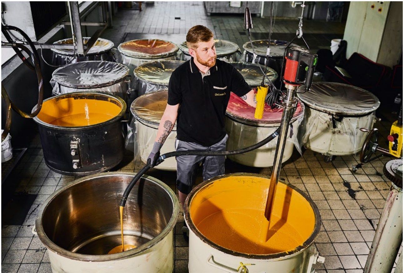
Der R32-Stator mit angeschlossenem Chemieschlauch von 1,5 m Länge eine Förderleistung von 30 l/min.
