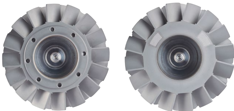
Die Wuchtebene beim konventionellen Wuchten mit Bohrungen (links) unterscheidet sich von der neuen Methode mit Laserablation (rechts).
