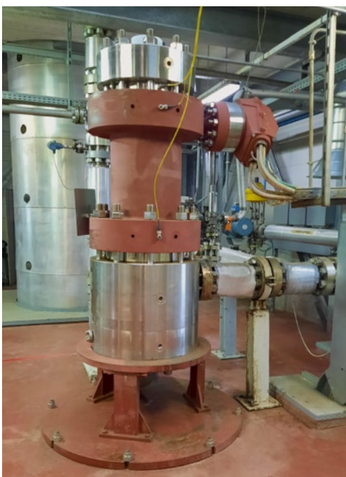
Die vertikale Spaltröhrenmotorpumpe in Hochdruckausführung mit Magnettraglager sorgt für verschleißfreien Betrieb.
