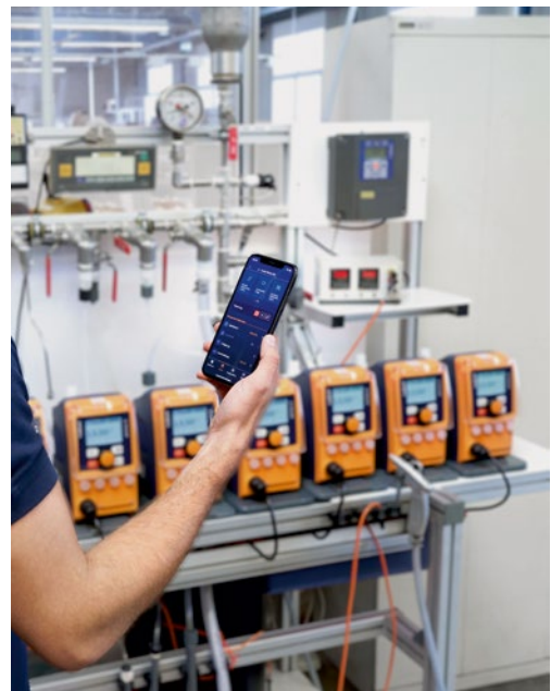
Per App können Mitarbeitende vom Smartphone aus Dosierpumpen steuern.
