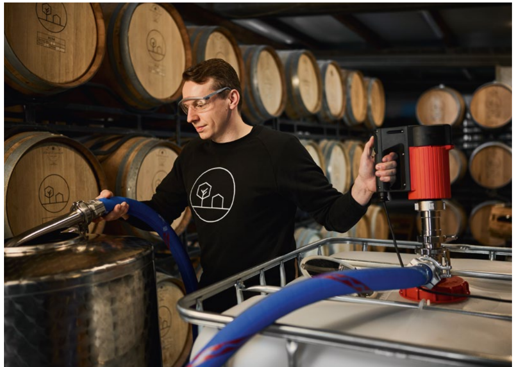
Agavendicksaft oder Fruchtsaftkonzentrate werden schonend und hygienisch zur weiteren Verarbeitung gefördert.
