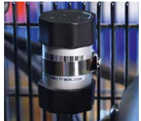
Der Tracker erfasst kleinste Erschütterungen und gibt sehr genau Auskunft über die Betriebszeiten von Stromaggregaten.
